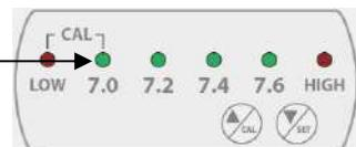
2/ Tremper la sonde pH dans une solution pH 7 (non fournie).
