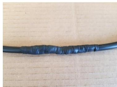
4. Hacer uso de tubo termorretractil, aplicando calor con un decapador hasta reducir su diámetro a la medida de la manguera. Dicho tubo, lleva resina en su interior que con el calor actúa como adhesivo.
