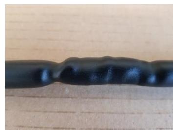
Para una correcta ejecución, se debe aplicar el calor desde el centro del tramo de tubo termorretractil hacia los extremos de forma progresiva y equitativa, evitando la formación de “bolsas de aire” en el interior. En ambos extremos debe asomar la resina sellante.
